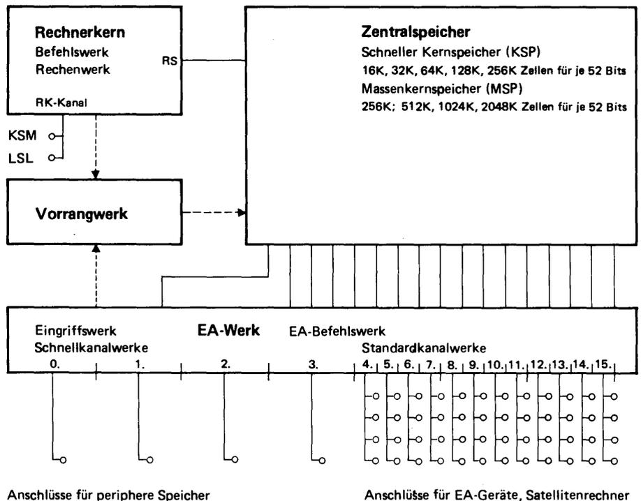
Bild 1 Digitalrechner RD 441 - Werke im Zusammenhang
