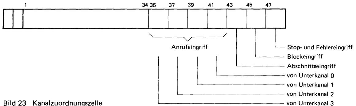
Bild 23 Kanalzuordnungszelle
