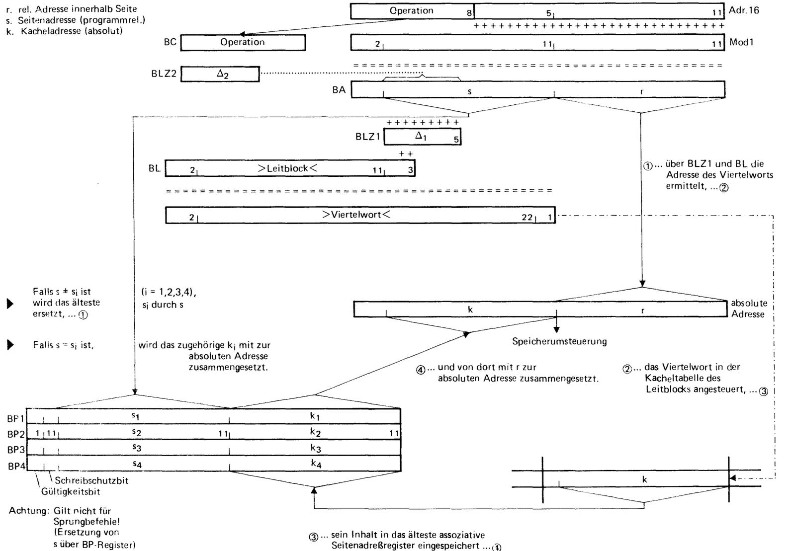
Bild 16 Ersetzung der programmrelativen 16-Bit-Adresse mit der Kacheladresse
