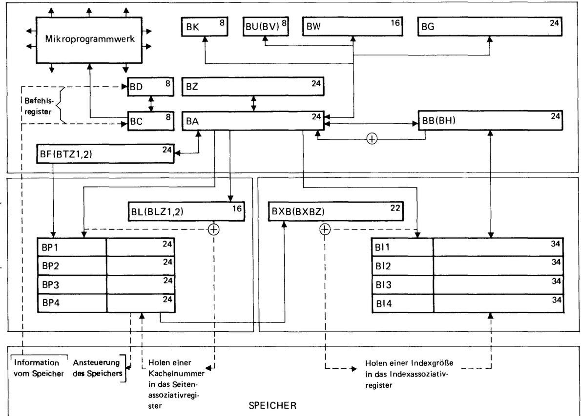
Bild 5 Blockschaltbild des Befehlswerks
