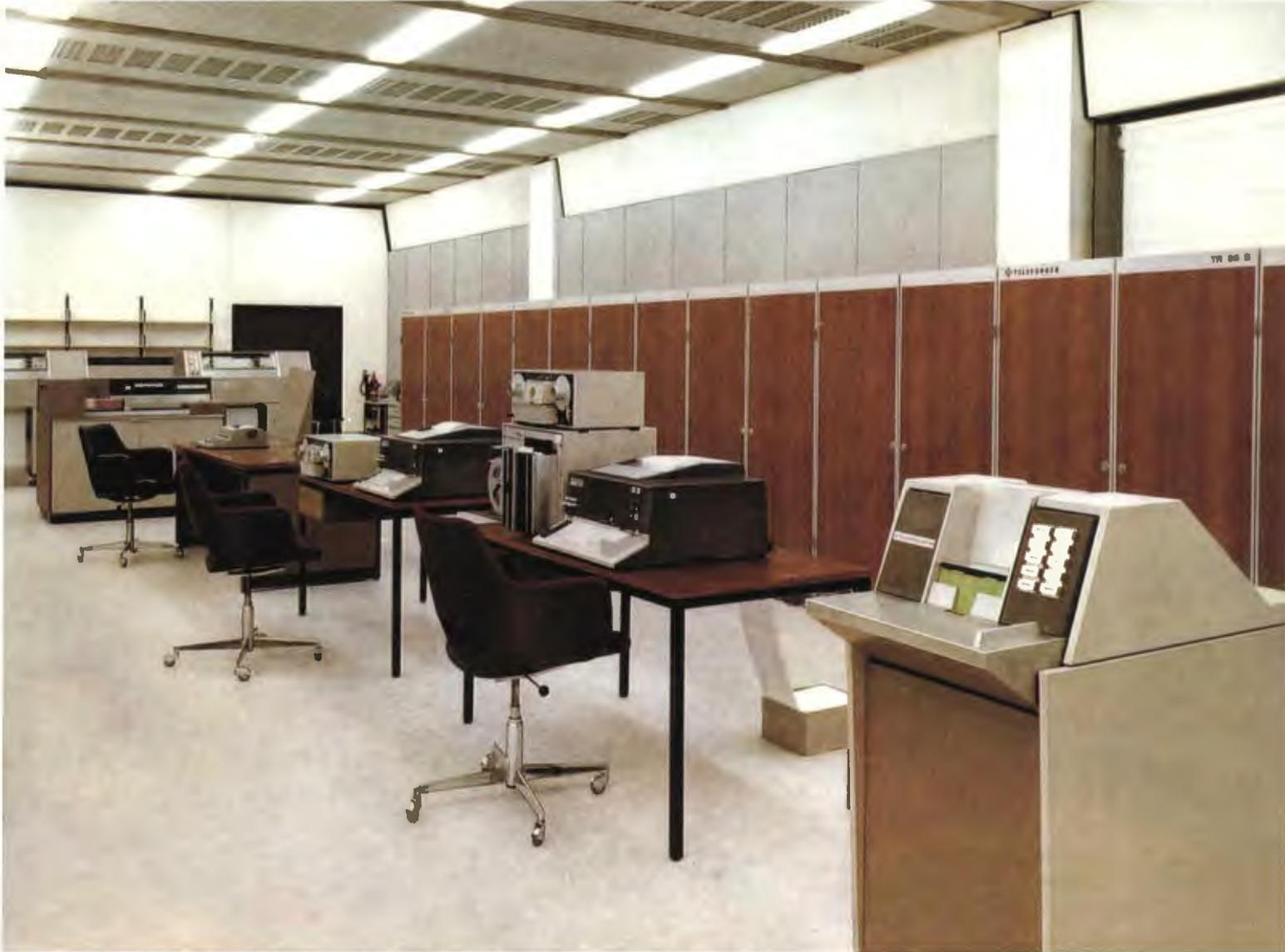
Teilansicht des Rechenzentrums der Ruhr-Universität Bochum. Die Bedientische gehören (von links) zur Zentraleinheit des TR 440, zum Satellitenrechner TR 86 und zu einem zusätzlichen selbständigen Rechner TR 86. (Dieses Bild und das Bild auf der Titelseite erscheinen mit freundlicher Genehmigung der Ruhr-Universität Bochum)
